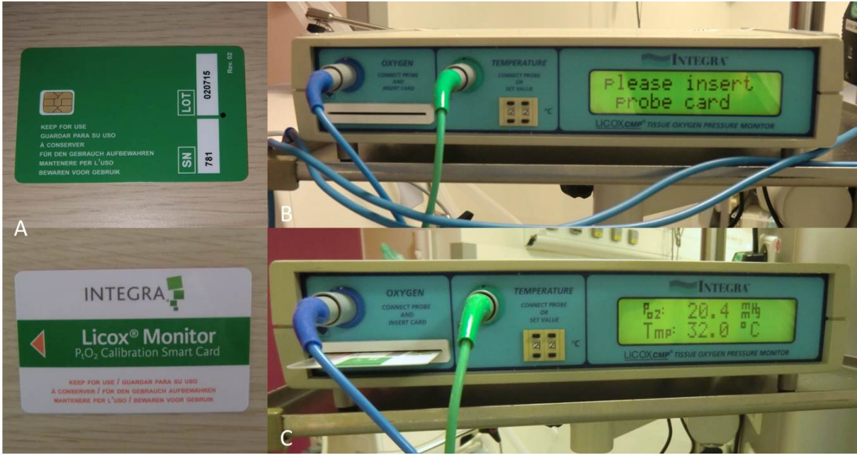
Figure 8 : A : Carte de calibration. B : Moniteur dans lequel il faut insérer la carte. C : Moniteur affichant le résultat des valeurs de PtiO 2 et de température intraparenchymateuse.
